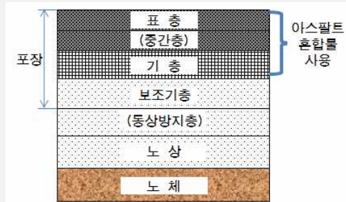
〈 아스팔트 콘크리트 포장 단면 구성 〉
