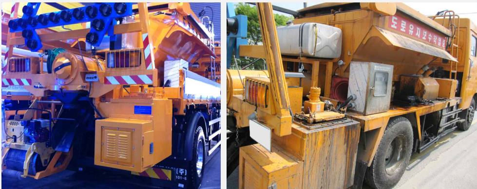
〈 유지보수용 아스팔트 혼합물 운반 장비 〉
