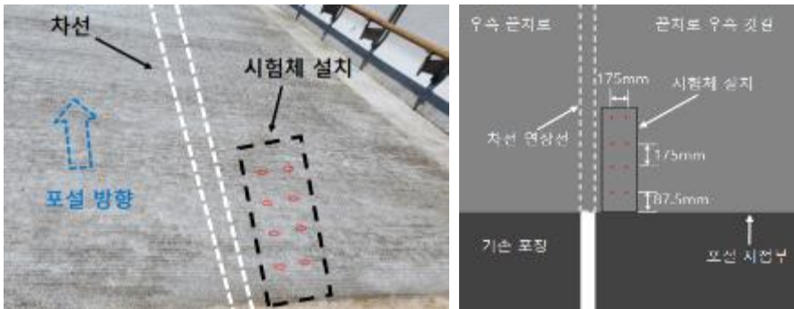
<그림 12> 우측 끝차로 포설시 현장 Pull out 시험 위치: 우측 끝차로 갓길부(측대 포함)
