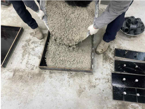
(a) 콘크리트 배합 후 모판 몰드 제작
