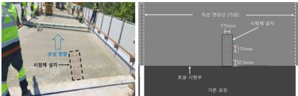
<그림 13> 다차로 구간 중 중간차로 포설 시 현장 Pull out 시험 위치: 차로 중앙부
