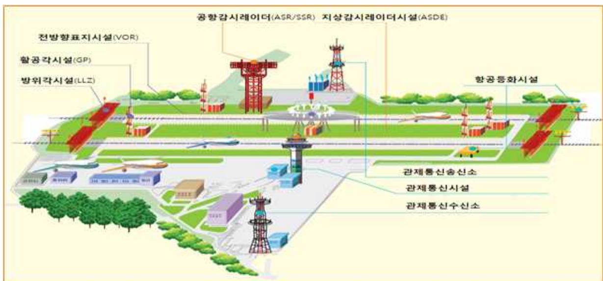
【 공항 내 항행안전시설 구축 및 운영 현황 】
