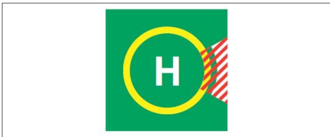
<그림 4-20> 해상구조물헬기장의 착륙금지구역 표지
