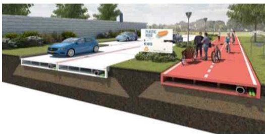
<조립식 도로 시공>
