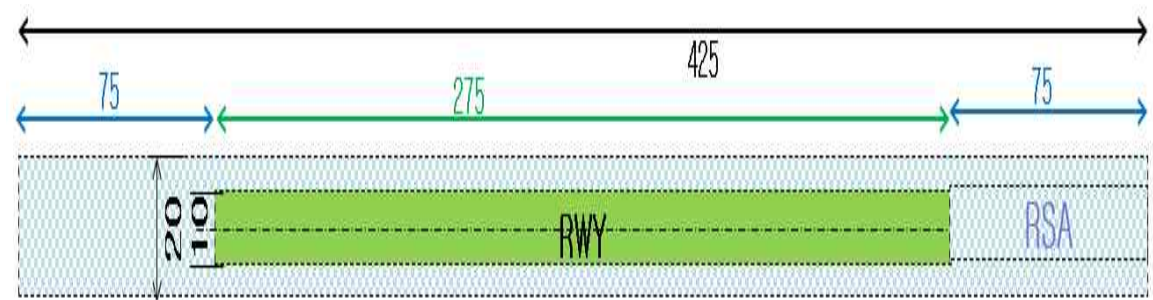
[그림 11] 활주로 양쪽에 안전구역을 설치한 활주로 평면도
