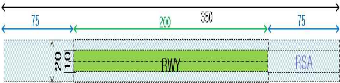
[그림 17] 활주로 양쪽에 안전구역을 설치한 활주로 평면도
