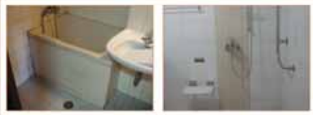
욕조를 사용 시설로 대체하고 접이식 의자 등의 편의시설을 설치하여 안전성 확보
